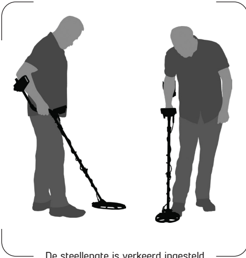
De steellengte is verkeerd ingesteld
