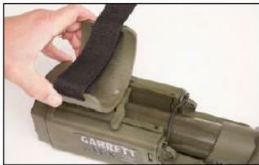
Armsteun bevestiging sluiten
