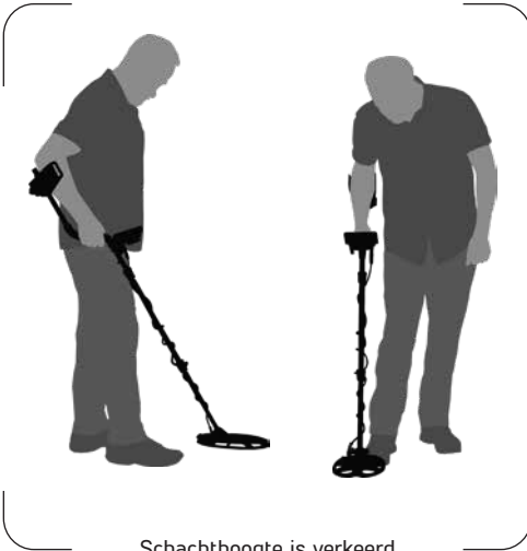
Schachthoogte is verkeerd
