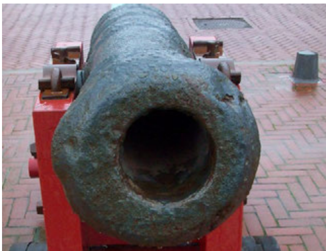
Afb. 86 Ook de ziel zit niet in het midden van de tromp. Dit zou een van de redenen kunnen zijn waarom het stuk is afgekeurd. - Fig. 86 The bore is not positioned in the centre of the muzzle. This could be one of the reasons why the gun was declared unfit for use.
