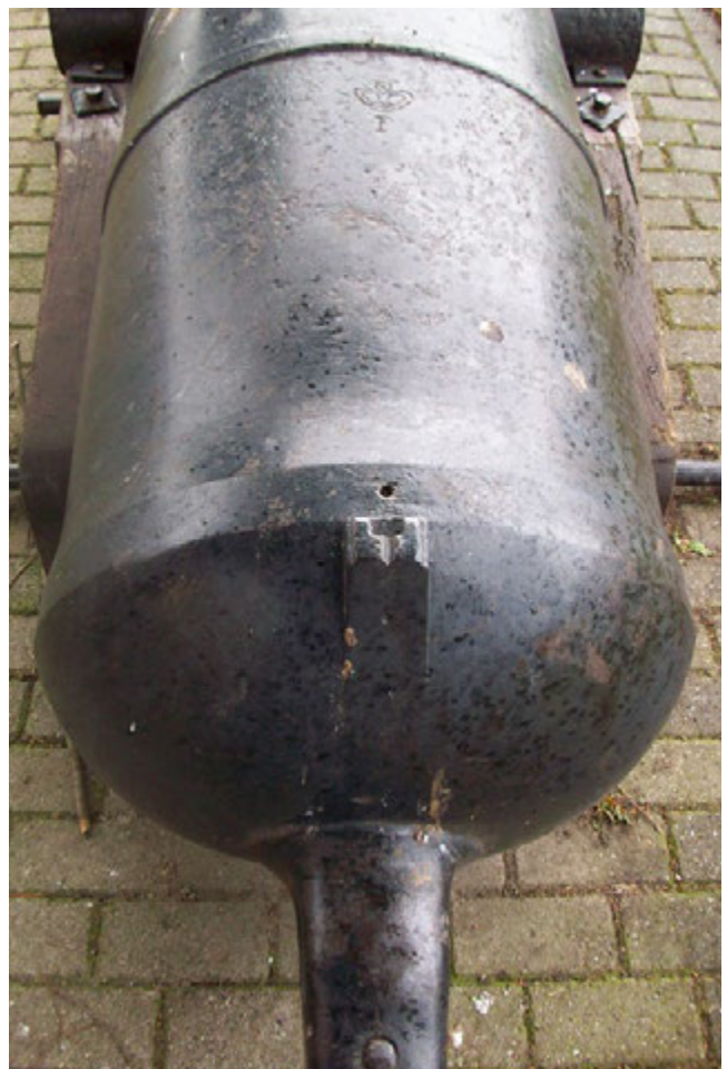
Afb. 549 Bodemstuk met het Engelse keurmerk. - Fig. 549 Breech with the English proof mark.
