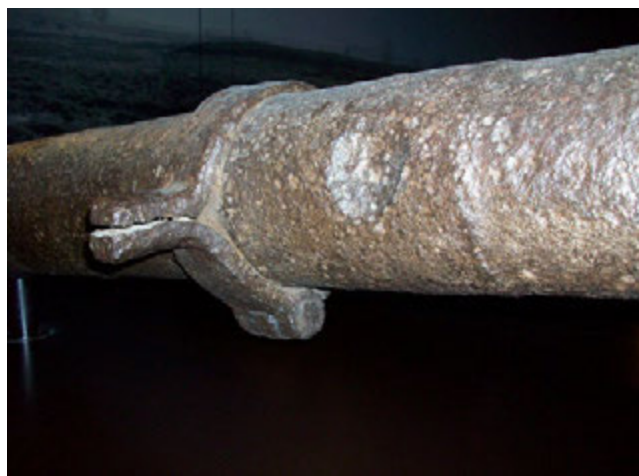
Afb. 80 Een kanon met litteken en 'nieuwe' aangesmede tappen. - Fig. 80 A scarred cannon with 'new' forged on trunnions.
