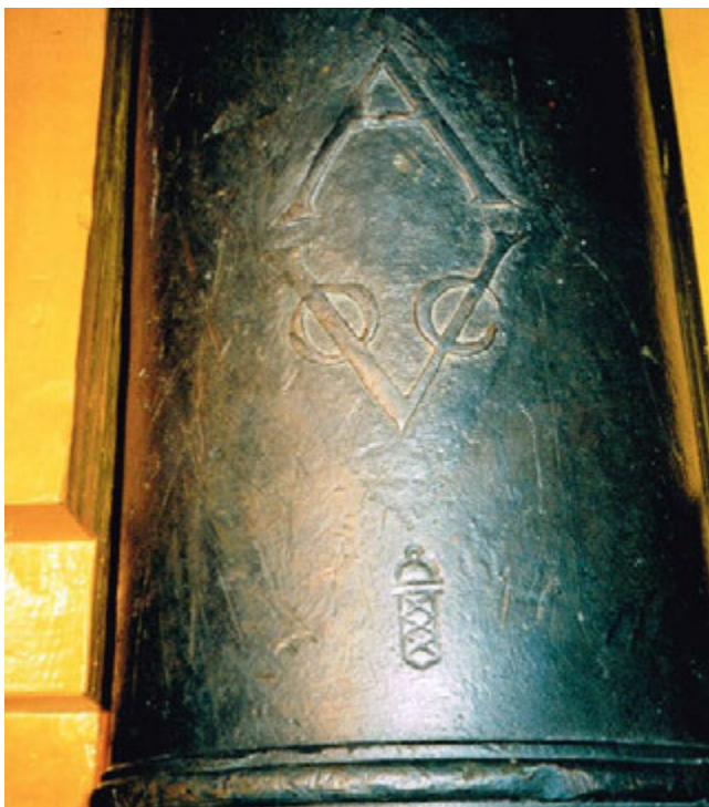
Afb. 213 VOC-merk en keurmerk op een kanon uit de Hollandia. - Fig. 213 Mark of the VOC and inspection mark on a cannon from the Hollandia.
