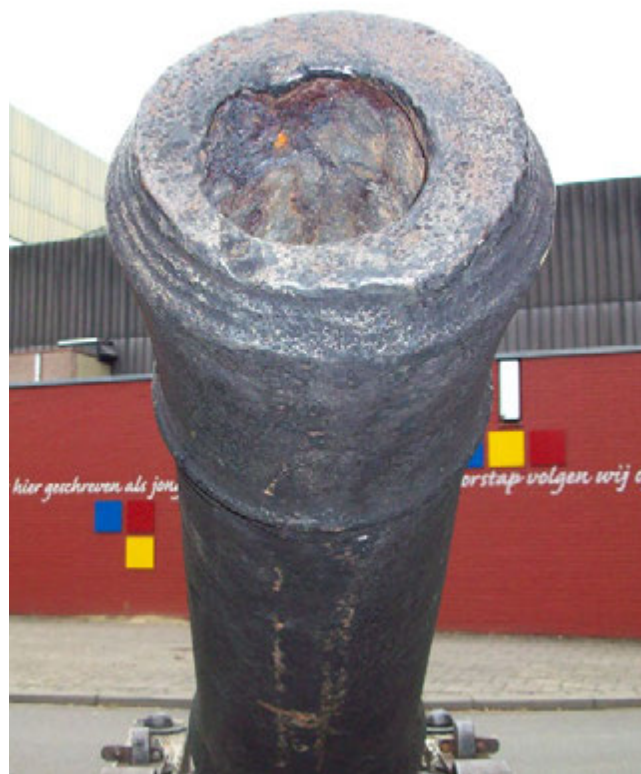
Afb. 88 Het kanon van Lochem heeft de mond ook niet in het midden van de tromp. - Fig. 88 The Lochem cannon, too, has an off-centre bore at the muzzle.
