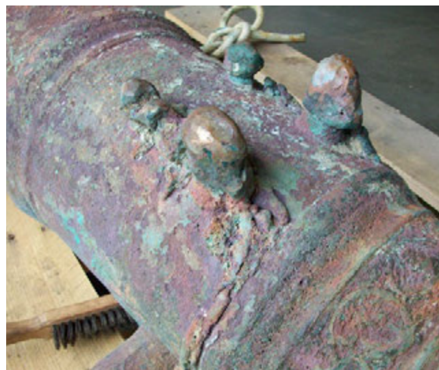
Afb. 207 Gesmolten dolfijnen en druppels metaal die naar beneden zijn gelopen. Het kanon is naar een privéverzameling gegaan. - Fig. 207 Molten dolphins and droplets of metal have run down the barrel. The cannon is now part of a private collection.
