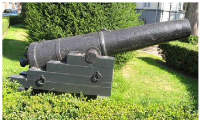
Afb. 571 Een granaatkanon 16 cm, 1865, gemaakt van een lange 30-ponder van de Engelse Walker Company, 1834, type 2. Het kanon staat in Zevenbergen. (foto Johan Opdebeeck) - Fig. 571 A 16-cm, shell gun, 1865, made of a type 2 long 30-pounder from the English Walker Company, 1834. This cannon is in Zevenbergen. (Photograph: J Opdebeeck)
