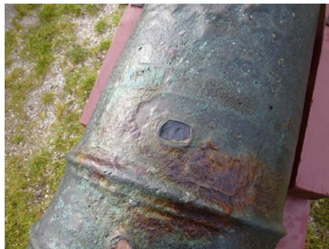
Afb. 95 Een kanon op Terschelling waarbij het kroonijzergat is dichtgemaakt met rubberkit. Het oude roestspoor is er nog. - Fig. 95 A cannon on Terschelling, where rubber sealant has been used to fill the chaplet hole. Old traces of rust can still be seen.
