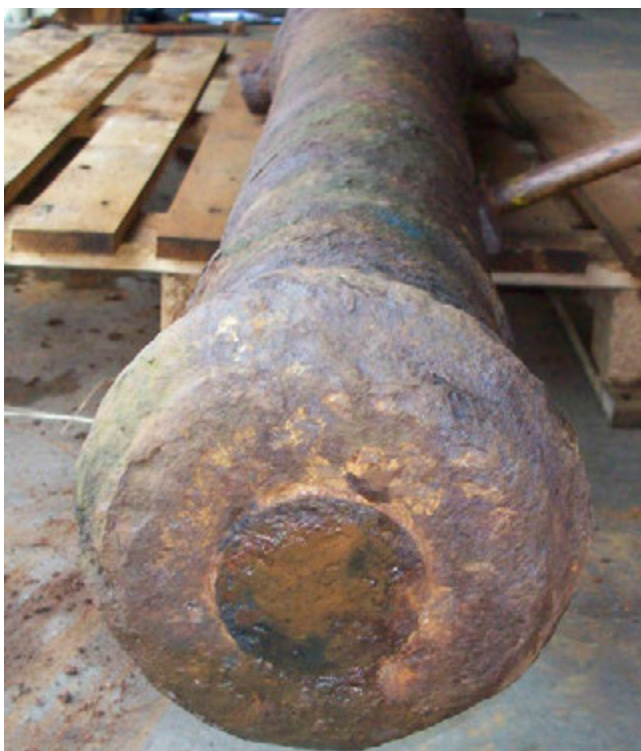
Afb. 135 Na meer dan 400 jaar zit er nog een houten prop in de mond, dus de lading is nog aanwezig. - Fig. 135 After more than 400 years, there is still a wooden tampion in the muzzle, so the cannon is still loaded.
