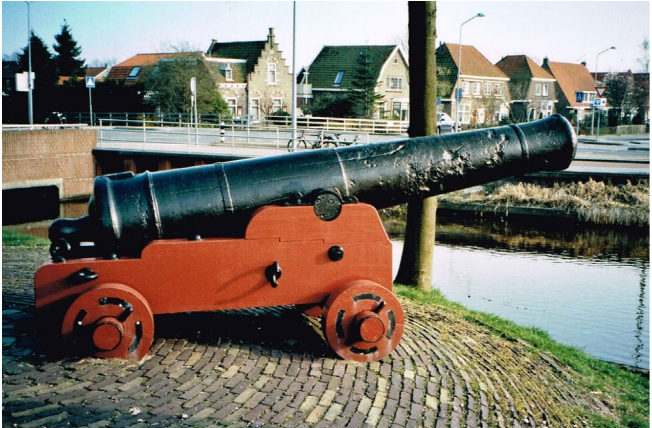
Afb. 46 Een Franse 18-ponder van het Manson-model in Monnikendam. - Fig. 46 A French Manson pattern cannon (an 18-pounder) in Monnikendam.
