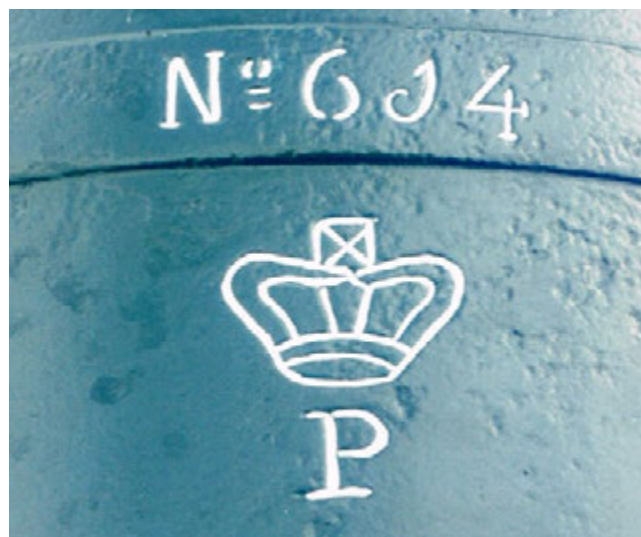
Afb. 560 Engels keurmerk Crown Proof, met het Nederlandse registratienummer in de band van de eerste breuk. - Fig. 560 English 'Crown Proof' mark with the Dutch registration number in the first reinforce ring.
