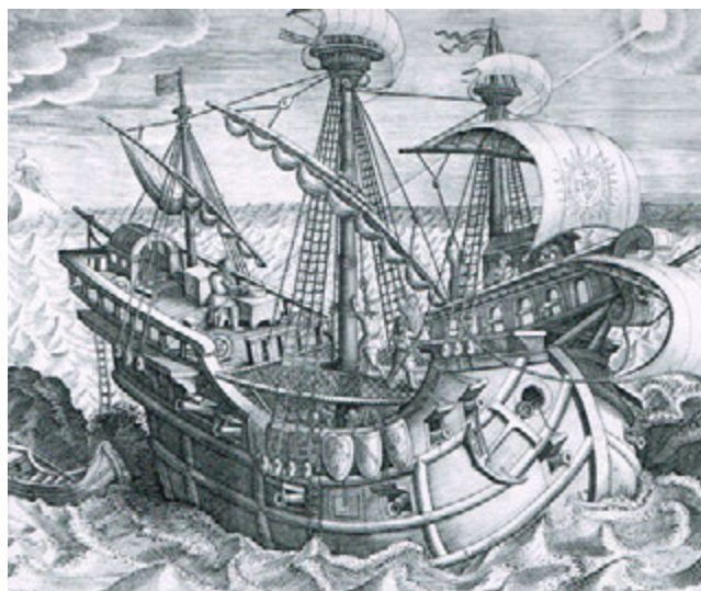
Afb. 24 Een hulk, een 15e eeuwse scheepstype, met geschut op landaffuiten op de bovenste dekken, afgebeeld op een plaat uit Nova Reperta van Stradanus (de Vlaming Jan van der Straet), circa 1590. - Fig. 24 A hulk, with cannon mounted on field gun carriages on the upper decks, depicted in an engraving from Nova Reperta by Stradanus (the Fleming, Jan van der Straet), circa 1590.
