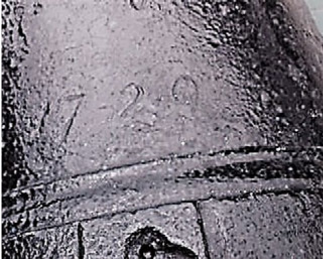
Afb. 53 Het Engelse gewicht staat voor het zundgat: 17-2-0 (zo schrijft men het Imperial Weight). - Fig. 53 The figures just in front of the touch hole indicate the gun's weight in English units: 17-2-0 (which was how the Imperial Weight was written).
