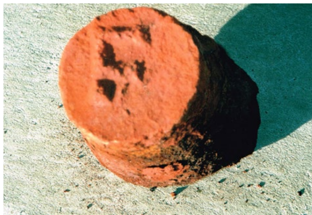
Afb. 52 Afgebroken tap van een Finsspångs kanon. - Fig. 52 Trunnion broken from a Finsspång cannon from a 1672 wreck.
