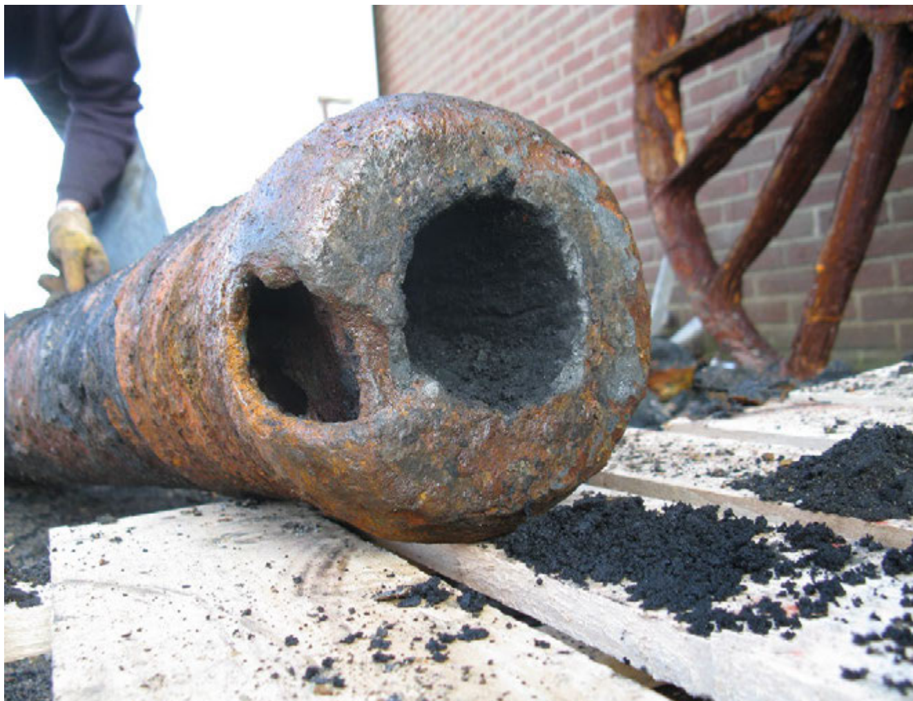
Afb. 92 Bij dit kanon is tijdens het gieten een luchtbel ontstaan, die pas zichtbaar werd door het roestproces op de zeebodem. - Fig. 92 An air bubble formed unnoticed in the metal of this cannon during casting
