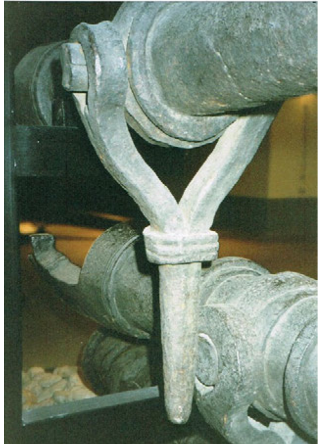
Afb. 12 Bassen met aangesmede tappen en een mik in het scheepvaartmuseum van Stockholm. - Fig. 12 Bases with forged on trunnions and an iron swivel mount at the Stockholm Maritime Museum.
