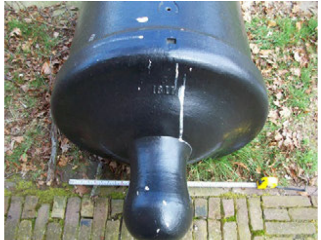
Afb. 517 Kulas van een van de 48-ponders in Oldebroek, met het gietnummer 6 en het gietjaar 1811. De verhoogde kruitpan ontbreekt. De buitendiameter is 70 cm. - Fig. 517 Breech of one of the 48-pounders in Oldebroek, with casting number 6 and year of casting 1811. There is no raised powder pan. The external diameter is 70 cm.
