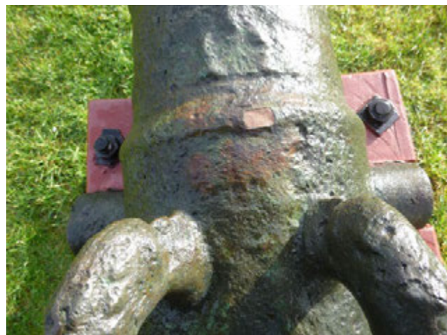
Afb. 96 Afgedicht gat van een kroonijzer vóór de tappen in het kanon van afbeelding 95. - Fig. 96 Sealed hole where the chaplet used to be, in front of the trunnions of the cannon shown in Figure 95.
