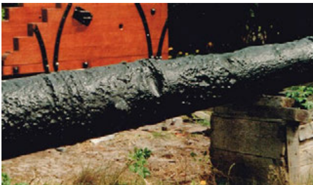
Afb. 82 IJzeren kanon uit het wrak BZN-2 bij Texel met 'kogelwond'. - Fig. 82 Iron cannon from the BZN-2 shipwreck near Texel, with a 'cannonball wound'.
