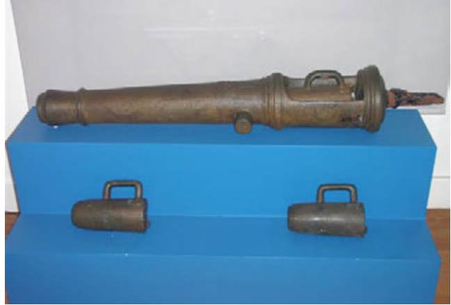
Afb. 400 Achterlaad draaibas met kruitkamers in Porto Santo. Foto: H. van Dieren. - Fig. 400 Breechloading swivel gun with powder chambers in Porto Santo. Photograph: H. van Dieren.
