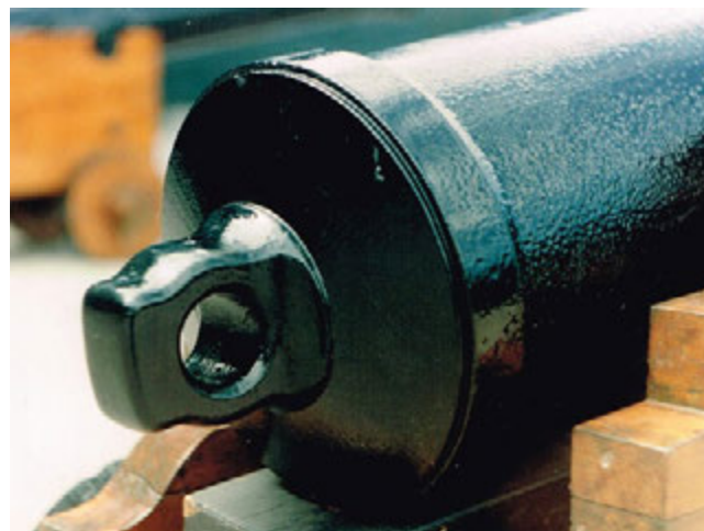
Afb. 535 De druif van een 6-ponder, model 1845, in Den Helder. Er zit een richtgroef boven in de kulasband. - Fig. 535 The cascabel of a 6-pounder, 1845 model, in Den Helder. There is an aiming groove in the top of the breech band.
