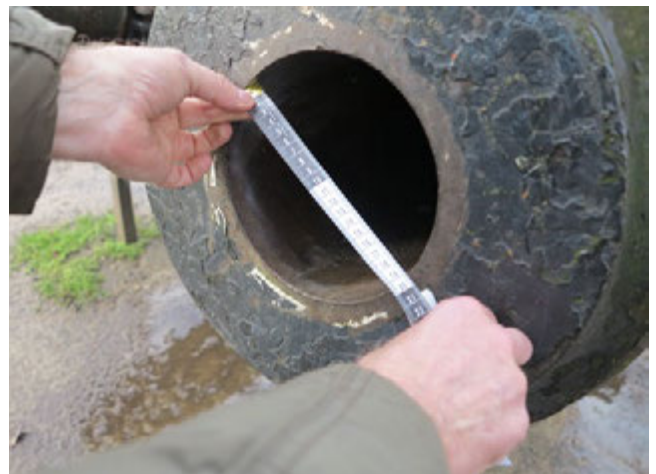
Afb. 518 De 48-ponder in Brussel heeft nog de originele zieldiameter van 19 cm. Hij ligt bij de Hallepoort. - Fig. 518 The 48-pounder in Brussels still has the original bore diameter of 19 cm. It is located close to the Hallepoort gate.
