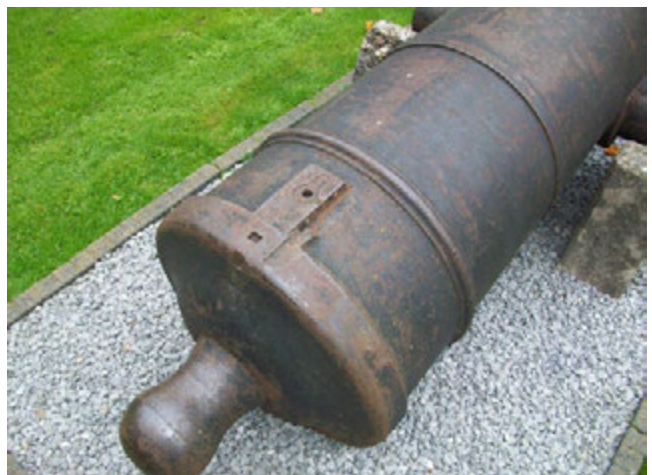
Afb. 514 Het kenmerkende bodemstuk van een kanon van het Manson-model met gewelfde stootbodem met daarop het gietnummer en jaartal boven de druif en een verhoogde kruitpan. Dit kanon staat bij het Museum Bronbeek in Arnhem. - Fig. 514 The distinctive back end of a cannon of the Manson pattern with a curved breech with the cast number and year above the cascabe and a raised powder pan. This cannon is at the Bronbeek Museum in Arnhem.
