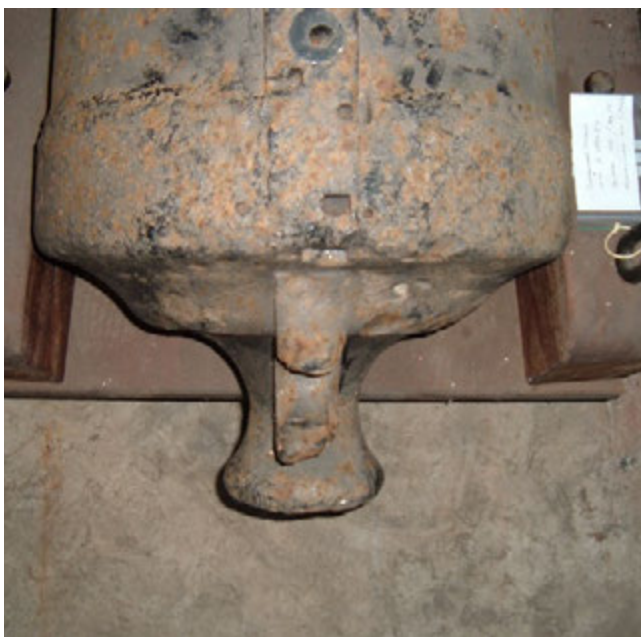
Afb. 525 De gewelfde kulas van een 30-ponder type 3, met broekingoog en afgeplatte druif in het Marinemuseum te Den Helder. - Fig. 525 The curved breech of a type 3 30-pounder, with the breech ring and flattened cascabel at the Den Helder Naval Museum.
