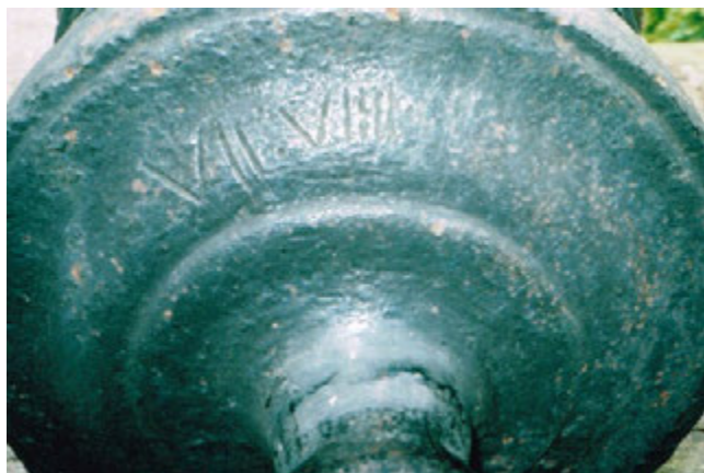
Afb. 482 Het cijfer op de kulas (7 skeppund en 9 lispund). - Fig. 482 The figures on the breech (7 skeppund and 9 lispund).
