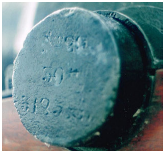
Afb. 545 Merken op de linkertap van een lange 30-ponder uit Luik bij het Marinemuseum in Den Helder: No 25, 30#, 3125 kg. - Fig. 545 Marks on the left trunnion of a long 30-pounder from Liège at the Naval Museum in Den Helder: No 25, 30#, 3125 kg.
