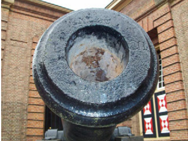
Afb. 547 Mond van de opgeboorde 36-ponder in Grave. Van het jaartal 1811 rechts mist een cijfer, waaraan je kunt zien dat het kanon is opgeboord. - Fig. 547 Muzzle of the reamed out 36-pounder in Grave. One figure from the year 1811 on the right is missing, showing that the cannon was indeed bored up.
