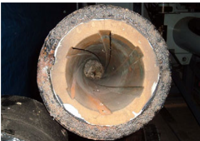
Afb. 568 Bronzen voering met trekken en velden in een lange 30-ponder uit Luik, 1825, in het Marinemuseum in Den Helder. - Fig. 568 Bronze liner with lands and grooves in a long 30-pounder from Liège, 1825, at the Naval Museum in Den Helder.
