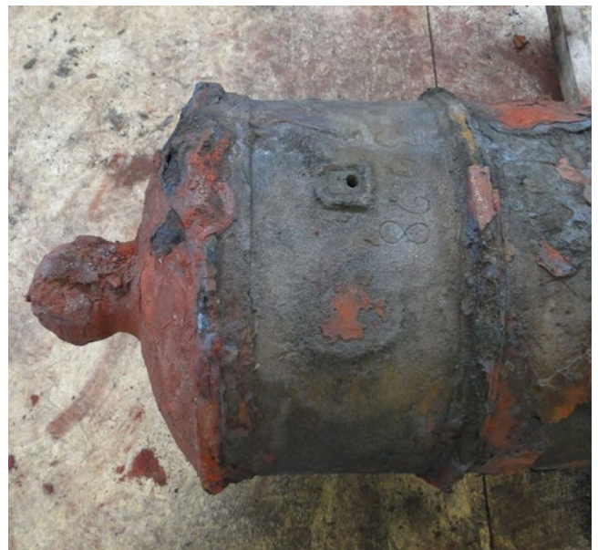
Afb. 495 Kulas met gewicht en kruitpan na het uitgloeien. Verbrande ijzer-oxide is nog aanwezig. - Fig. 495 Breech showing the weight and flash plan, following annealing. The burned iron oxide is still present.
