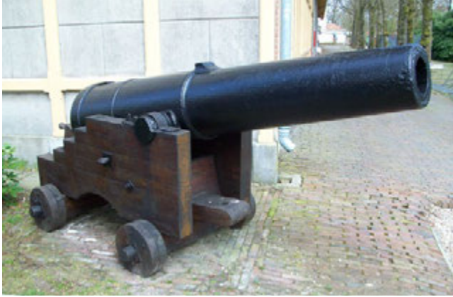
Afb. 566 Een getrokken kanon van 16 cm (1865), gemaakt van een lange 30-ponder uit Luik (1825), type 3, in het Nederlands Artillerie Museum Oldebroek. - Fig. 566 A rifled 16-cm cannon (1865), made of a long 30-pounder from Liège (1825), type 3, at the Netherlands Artillery Museum in Oldebroek.
